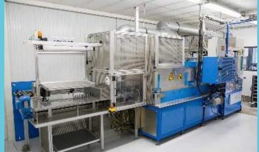
Trempe thermique des tubes
