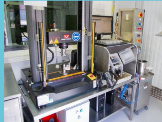
Contrôle de tenue mécanique des tubes
