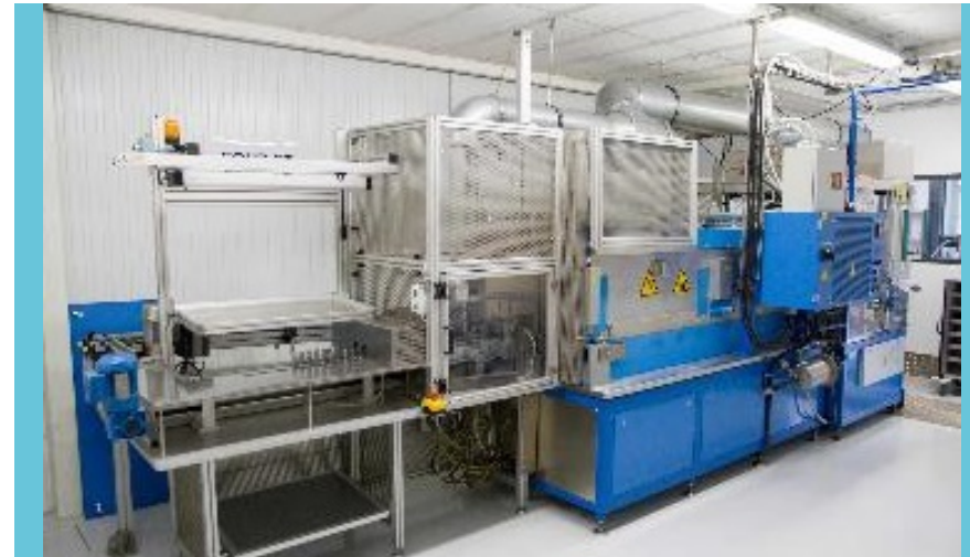
Trempe thermique des tubes
